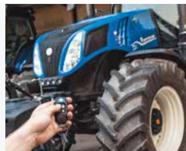
Фабрично инсталирано дистанционно заключване и имобилайзер.
